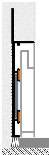
Installazione con fuga da 3 mm
